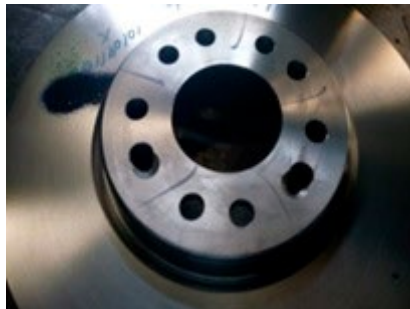
Figura A1. Parte con defecto de barrenado
